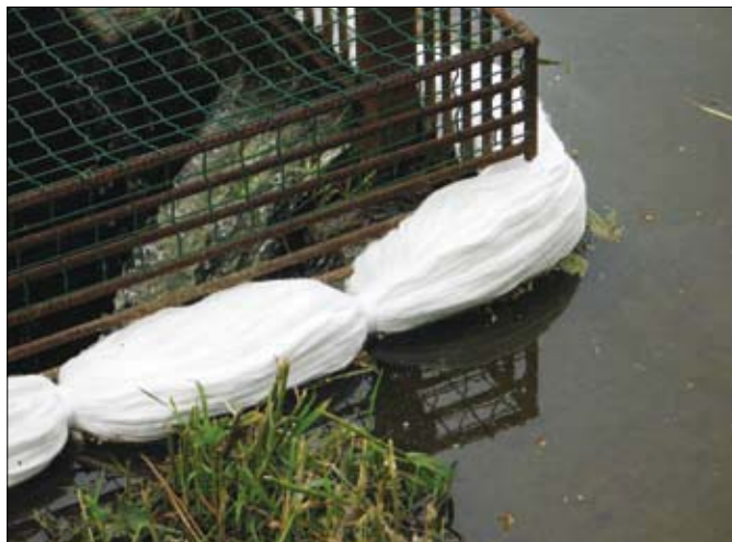
Применение составных волокон REO Fb на воде
