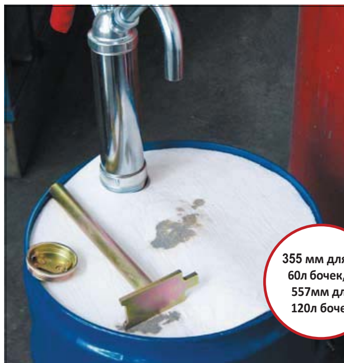
Салфетка впитывает капли жидкости, упавшие с помпы во время откачивания жидкости из бочки
