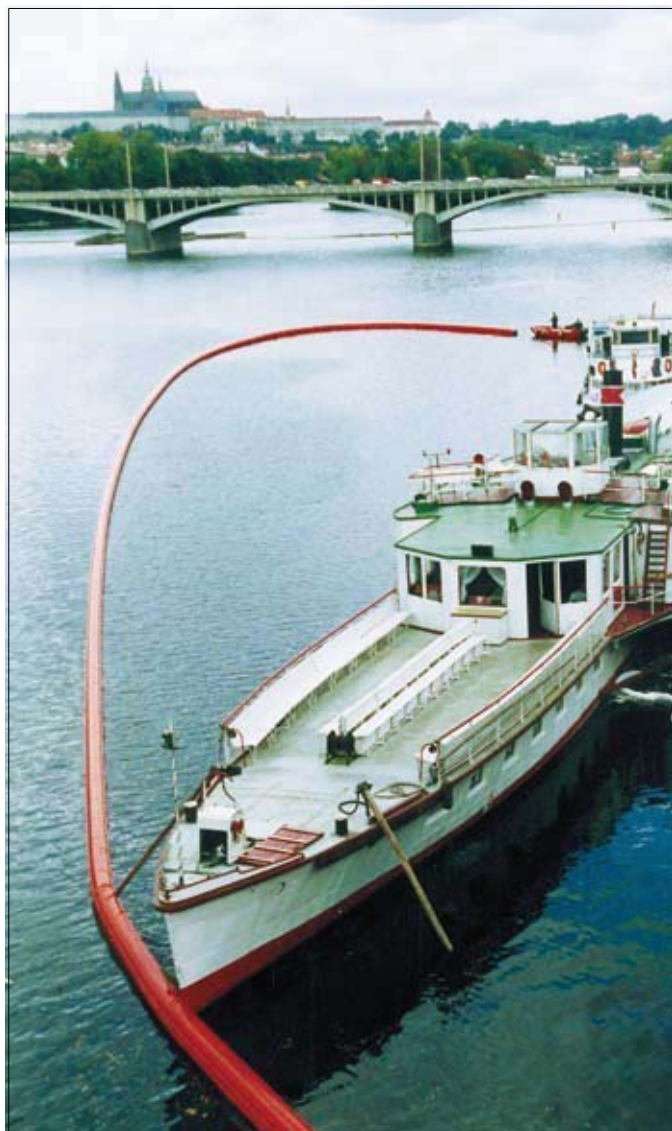
При использовании на воде большая верхняя камера наполняется воздухом, а нижняя - водой
